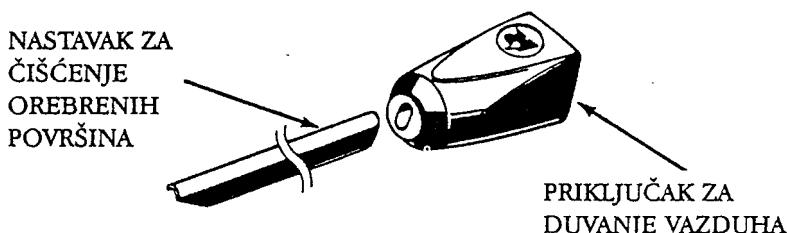
Za čišćenje teško pristupačnih površina, kao što su površine ispod i iza frižidera, koristite ovaj nastavak. Skinite malu cevčicu za duvanje sa priključka i zamenite je ovim dugačkim nastavkom. Dobro je ugurajte u ležište. Stavite Rainbow crevo na usis vazduha Rainbow uređaja i spremni ste za čišćenje.
