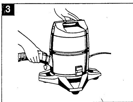
**3** Stavite metalni kraj od električnog creva u usisni otvor Rainbow usisivača dok ne klikne.
