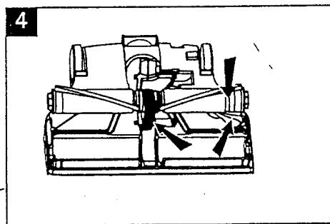
**4** Namaknите novi remenik oko osovine četke do njene sredine. Postavite osovinu četke sa gornje strane motora tako da remen može da dohvati do osovine motora. Namaknите remen na osovinu motora.
