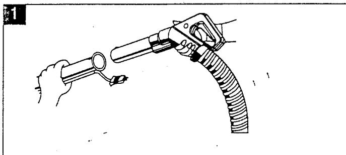
**2** Uključi električni kabal od Power Nozzle-a u utičnicu koja se nalazi na rukohvatu električnog creva kao što je prikazano na slici. NEMOJTE stiskati prekidač unutar rukohvata.
