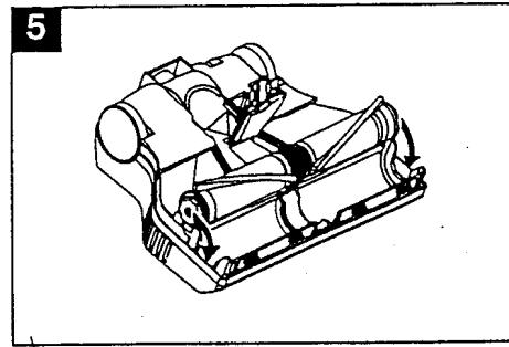
**5** S remenom koji je oko osovine motora i oko sredine četke, namestite krajeve četke u svoje ležište. S dve ruke pritisnite četku napred dok se dobro ne smesti u ležištu. Zavrtite četku rukom, dok se remenik ne centriira na sredini osovine četke.
